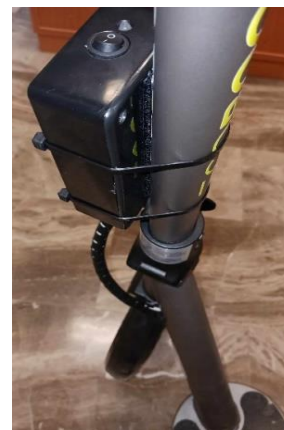
Εικόνα 2. 11 Τοποθέτηση διάταξης καταγραφής ενεργειακής κατανάλωσης πάνω στα μικροσχήματα
