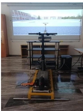
Εικόνα 3. 7 Προσομοιωτής ηλεκτρικού πατινιού
