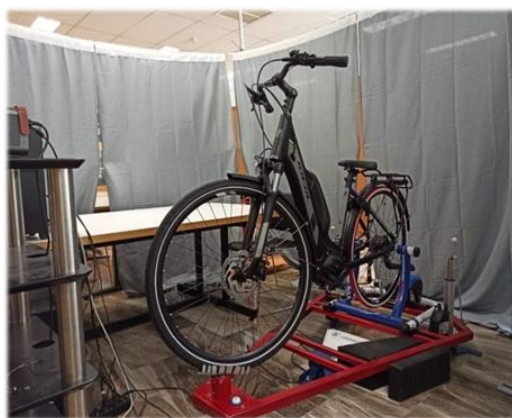
Εικόνα 3. 1 Προσομοιωτής ηλεκτρικού ποδηλάτου
